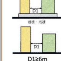
附圖 3 鄰棟間隔及退縮距離圖例
